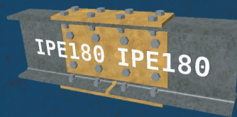
Αποκατάσταση συνέχειας δοκού
